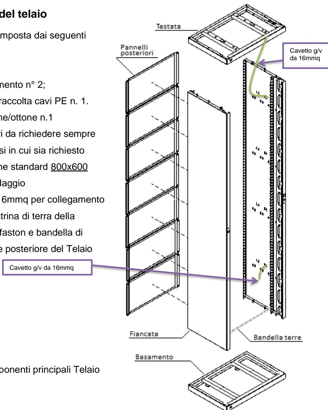
Figura 14 Componenti principali Telaio
