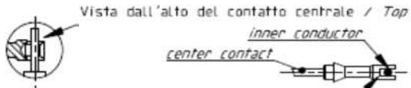
6. Crimpare mediante l'apposita pinza La crimpatura deve essere eseguita in modo tale da interessare solo il 90% della lunghezza del tubetto. La quota non interessata dalla crimpatura deve essere quella lato cavo
