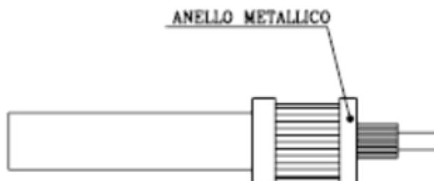
Figura 100 - Inserimento dell'anello metallico
