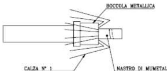
Figura 97 – Asportazione guaina e inserimento della boccia metallica
