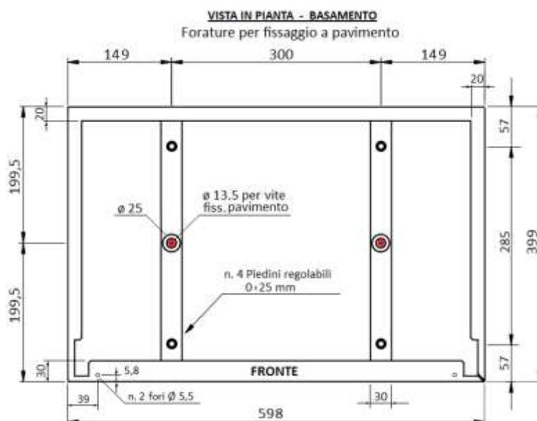
Figura 23 Piano foratura per fissaggio a terra
