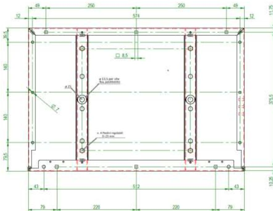
Figura 24 piano di foratura per fissaggio del soprazzo
