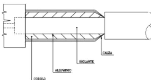
Figura 89 - Inserimento del cavo nel connettore
