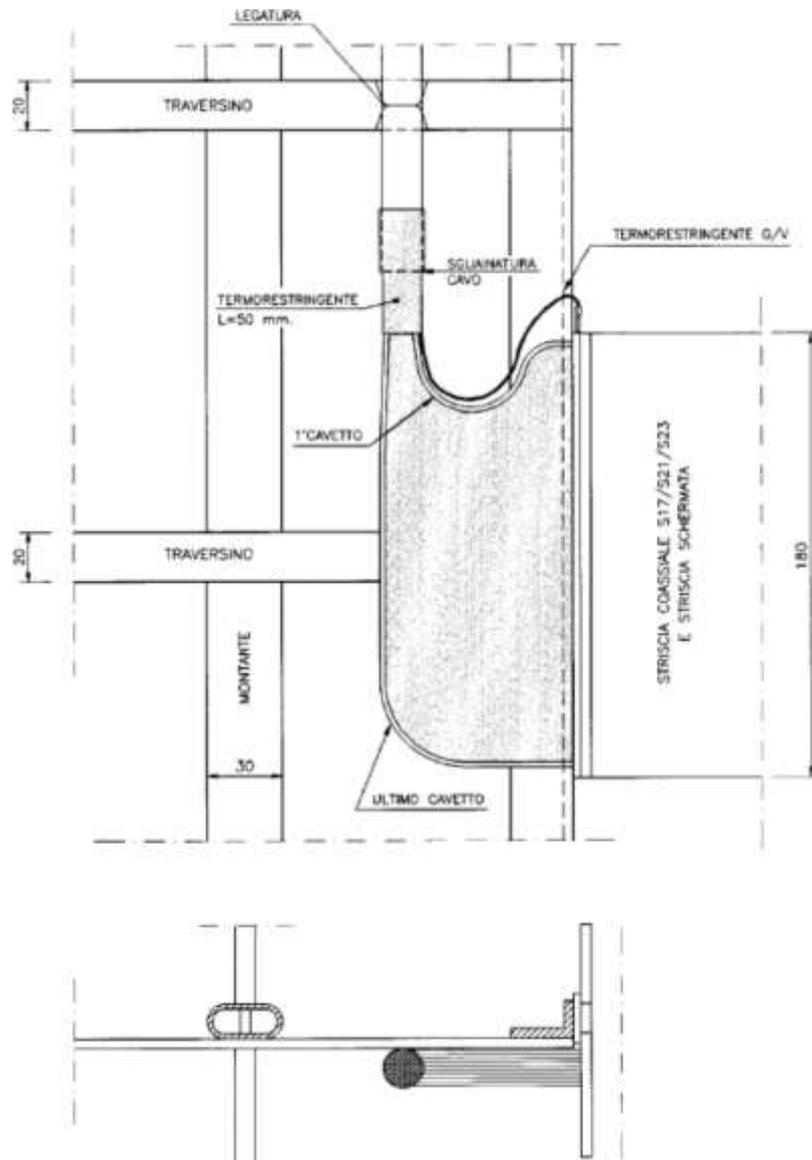
Figura 67 Sagomatura dei cavi AF con schermo elettromagnetico su Ripartitore (Lato Verticale)
