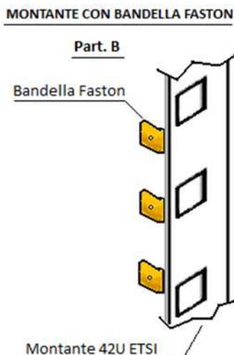
Figura 19 Particolare B bandella faston su montante dx
