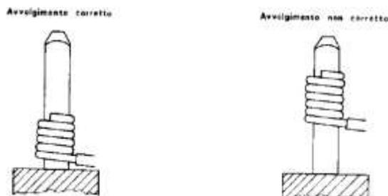
Figura 55 – Distanza della connessione dal supporto striscia (corretto quello di sx, non corretto quello di dx)
