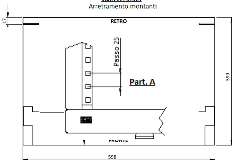
Figura 26 Piano posizionamento montanti ETSI
