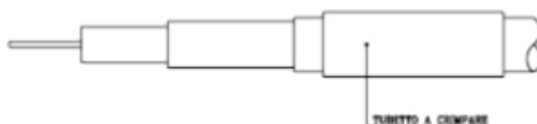
Figura 86 - Inserimento del tubetto a crimpare
