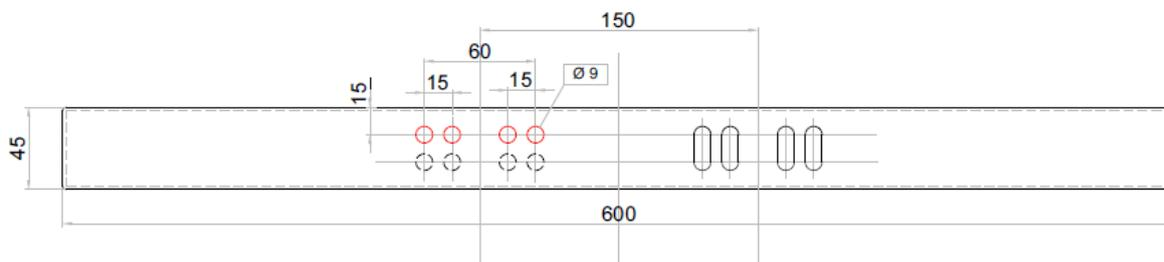
Figura 25 Piano di foratura per fissaggio biscotti
