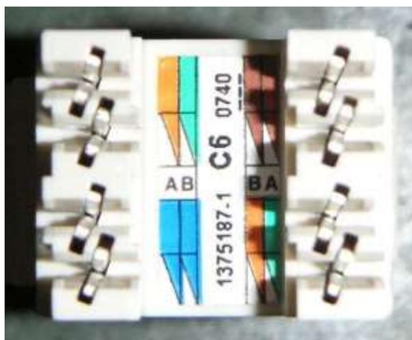
Figura 63 – Esempio di connettore femmina lato striscia
