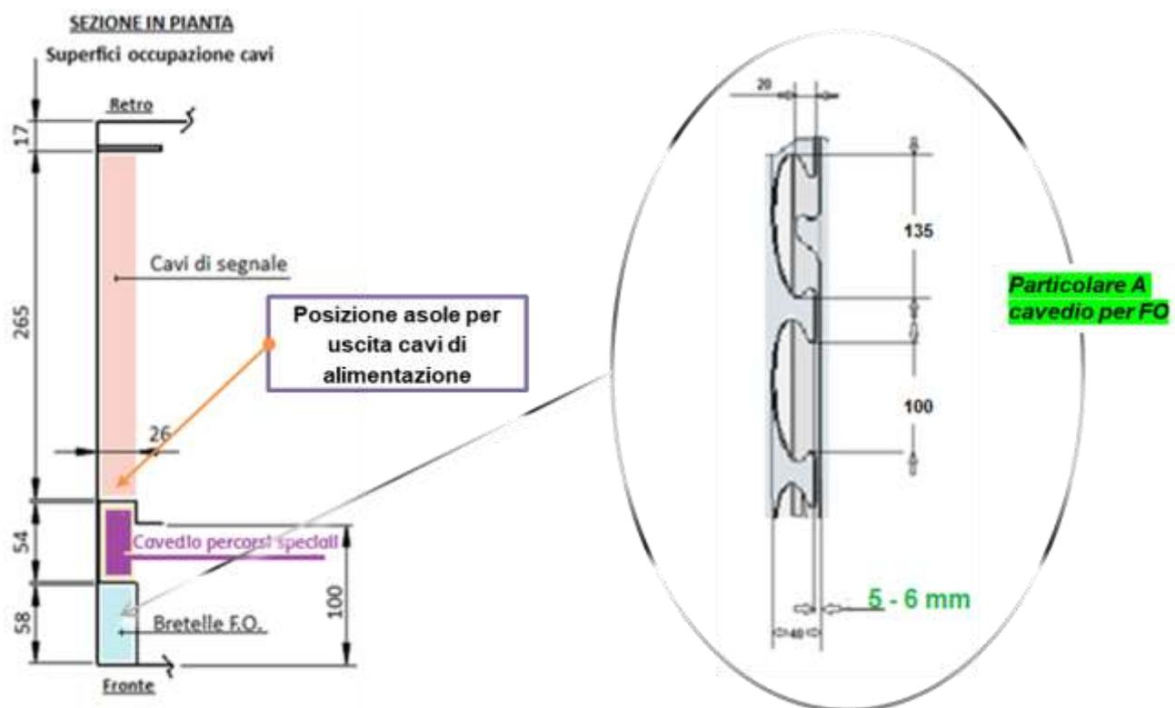
Figura 16 Superfici di occupazione cavi all'interno del Telaio
