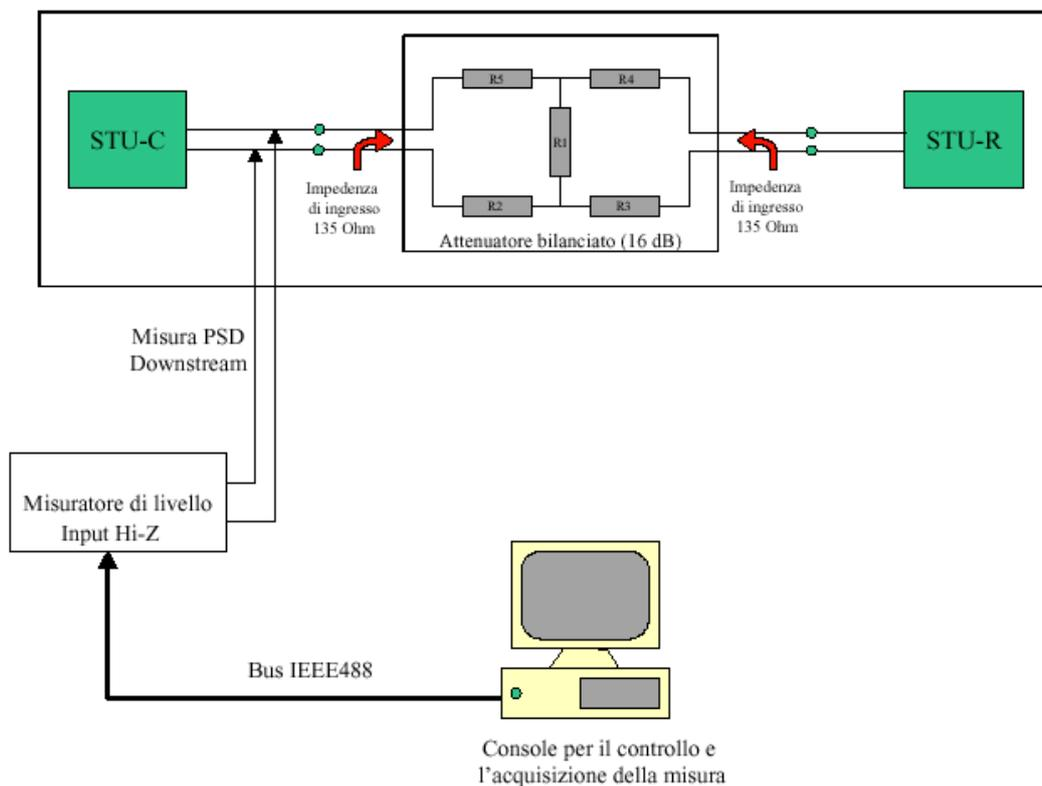
Sono eseguite le misure della densità spettrale di potenza trasmesse sia dall'STU-C sia dall'STU-R per i quattro profili di livello fisico con i seguenti *bit rate*: 384, 768, 1024, 2048 kbit/s ed è verificata sia la conformità alle maschere standard sia la conformità ai limiti di potenza totale trasmessa imposti dallo standard G.991.2.
