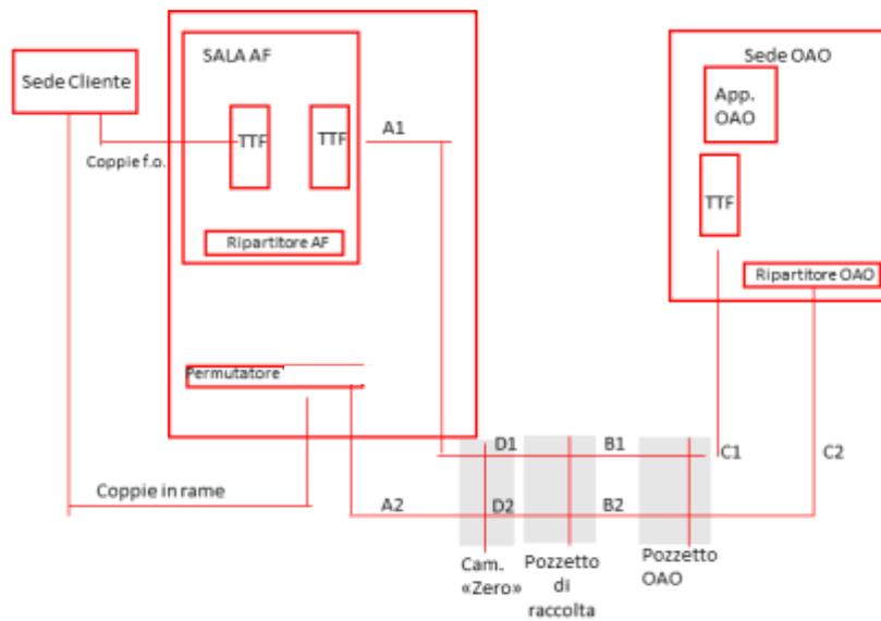
Legenda: Cavo A1 = Cavo B1 = Cavo C1 = Cavo D1= Cavo ottico;
