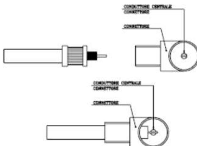
Figura 101 - Inserimento del cavo nel connettore
