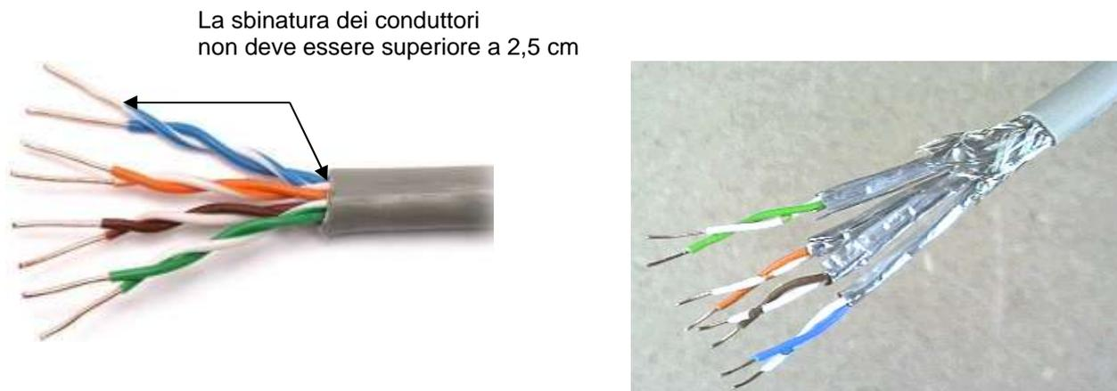
Figura 58 – Esempio di sguainatura del cavo UTP/STP
