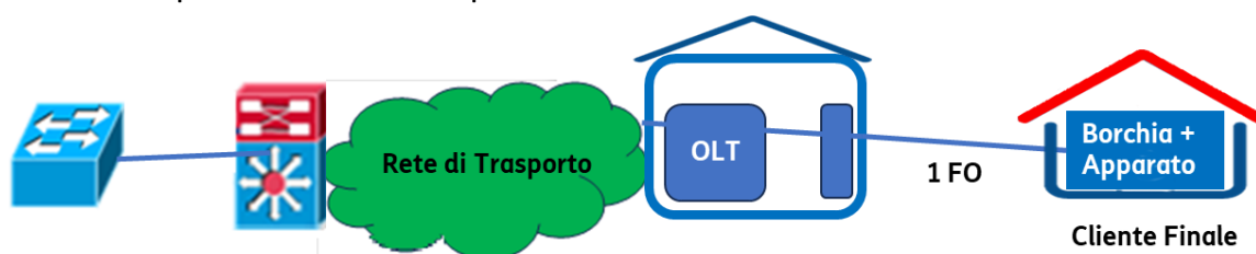
Figura 1: Schema impiantistico FTTO per velocità inferiori o uguali a 1 Gbps
