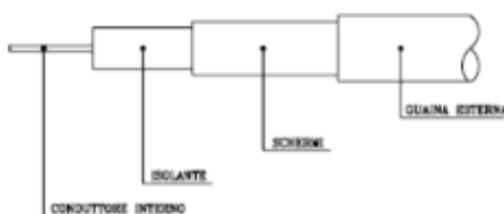
Figura 85 Disarmo del cavo
