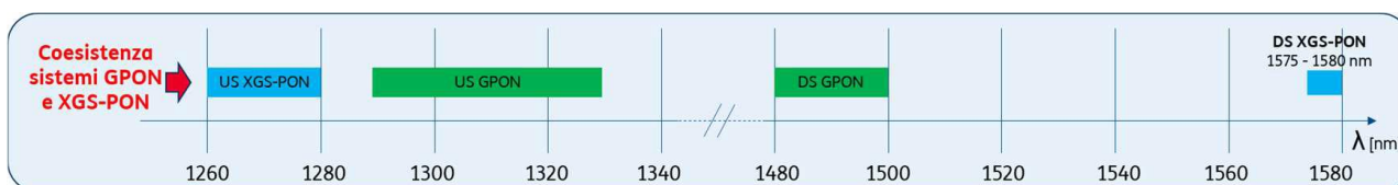
Figura 4 – Bande spettrali GPON e XGS-PON
