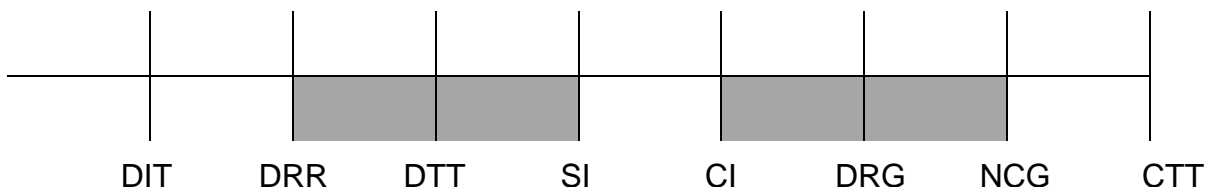
Figura 8: Tempi per il ripristino del servizio
