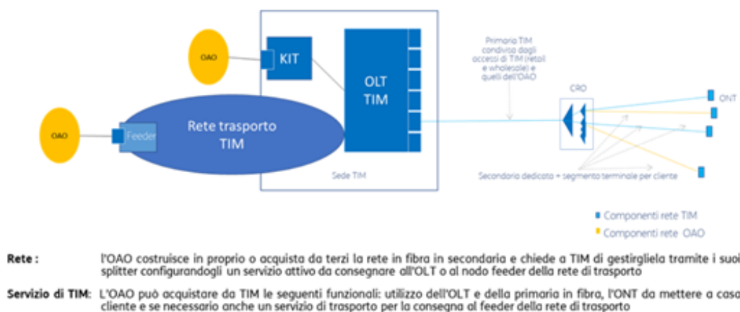
Figura 1: schematizzazione delle componenti di rete sottostanti ai nuovi “Servizi Accessori FTTH”
