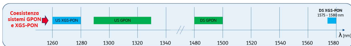
Figura 1 – Bande spettrali GPON e XGS-PON
