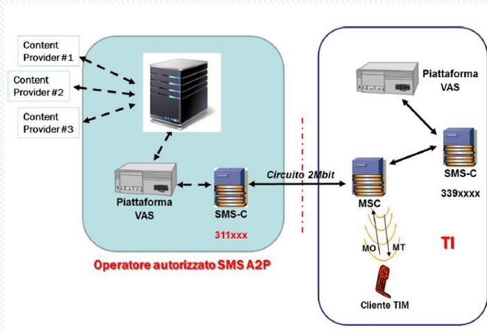
L'invio degli SMS avviene grazie al collegamento tra l'SMS-C di TIM e dell'Operatore realizzato attraverso un'interconnessione diretta tra la rete mobile TIM e quella dell'Operatore. Tale collegamento può essere realizzato utilizzando il protocollo standard MAP/SCCP/SS7.
